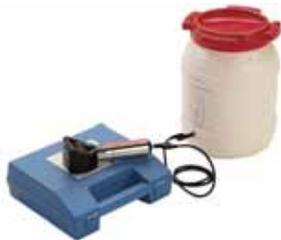
Este probador tiene por objeto verificar la conformidad de los guantes de utilización eléctrica antes de su uso. Es de USO EXCLUSIVO PARA LOS GUANTES DE COMPOSITE.
